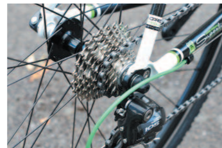
Anders als an der Gabel gibt's am Felt-Hinterbau keine Gewindeösen
