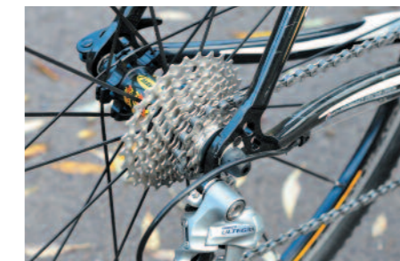
Unlackierte Klemmstellen erleichtern das Ausbauen des Hinterrades
