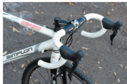
Keine Zusatzbremsgriffe, dafür aber Justageschrauben am Simplon-Lenker
