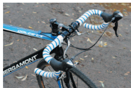
Alles dran am Kompakt-Lenker: Zusatzbremsgriffe und außen liegende Züge
