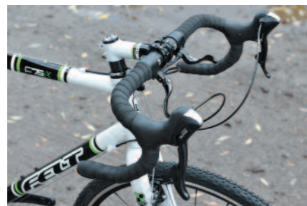
Gut: Vorbau in Rahmenfarbe und Einstellschrauben an den Schaltzügen
