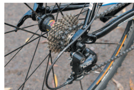
Die stämmigen Ausfallenden verbergen Gewindebohrungen zur Schutzblechmontage
