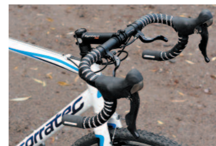
Komfortabler schlanker Syntace-Lenker mit gummierten, supergriffigen Lenkerenden
