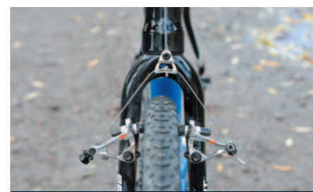
FSA-Crossbremse: im Gelände stark genug, auf der Straße vibrationsfördernd
