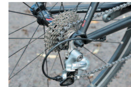
Klassische Zugführung am schlanken Hinterbau des Quantec
